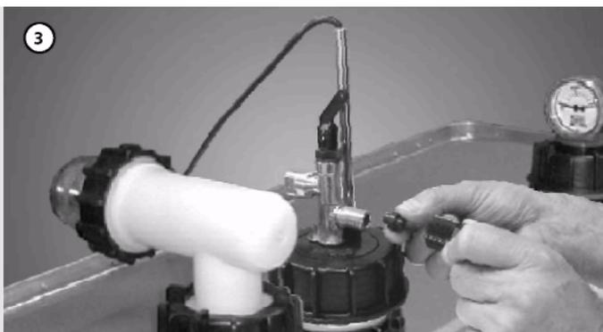
Закройте соединение к следующему резервуару с помощью концевой заглушки и гайки с прямой накаткой.
