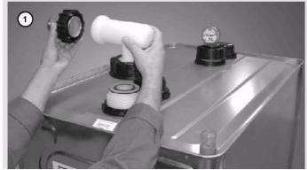
Установите резервуар на ножки. Ввинтите часы с указателем уровня заполнения в резьбовую втулку на третьем штуцере резервуара. Угловую заливную трубу с соединением для заполнения LORO-X установите на первый штуцер резервуара вместе с вставленной погружной трубой. Смажьте уплотнительные коль-
