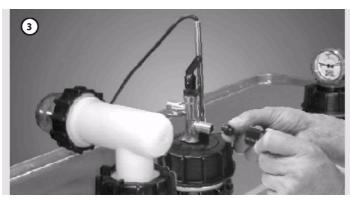
Закройте соединение к следующему резервуару с помощью конце-
